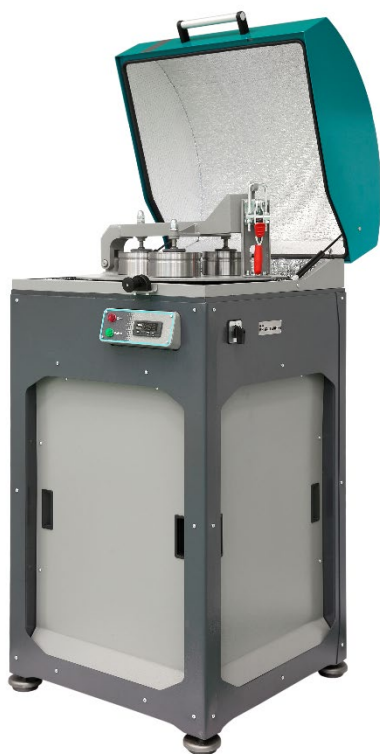
Рис. 1. Истиратель вибрационный ИВ 3М с тремя Чашами V900
